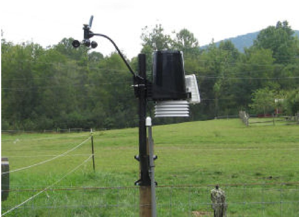
**Figura 4.3:** Estación meteorológica automática Davis Vantage Pro2.
