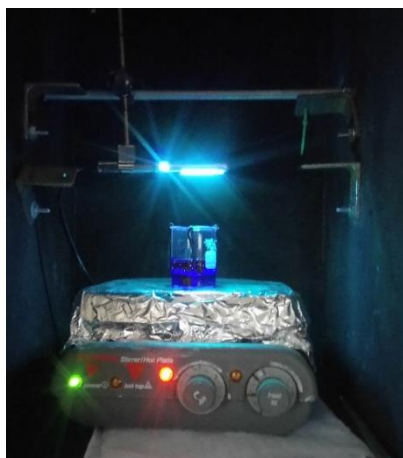
Figura 11. Reactor de fotocatalisis.
