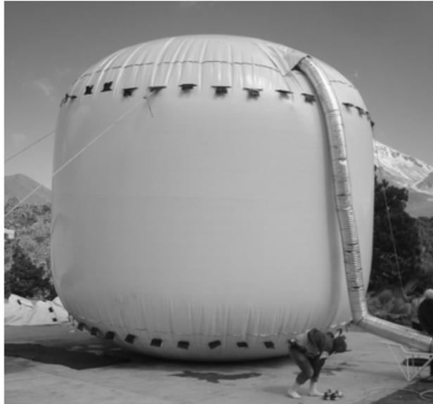
Figura 5.3: Vejiga de agua de un tanque de HAWC. La vejiga está soportada en el tanque por un cilindro de acero corrugado. Ésta contiene el agua y alberga los PMTs.
