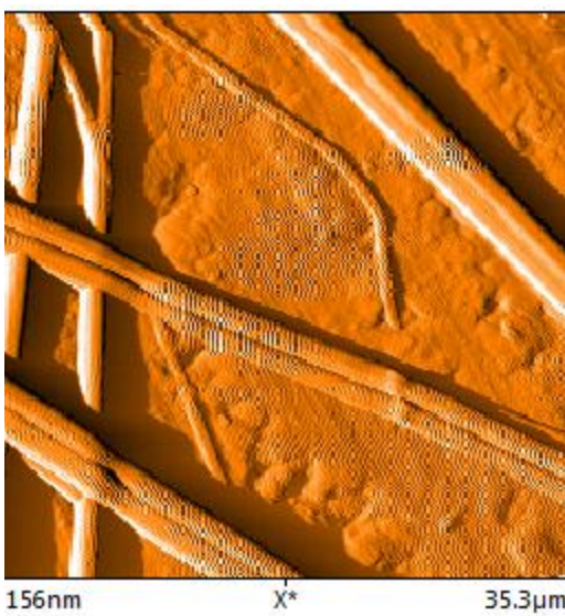
Figura 73. Microfibras sintetizadas con 9 kV, 8 cm, 0.3185 g/mL y 4 mL/h
